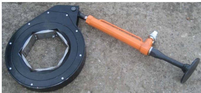
CH.S180 echipata cu adaptor hexagonal permite strangerea/ desfacerea piulitelor/ suruburilor M100x4
