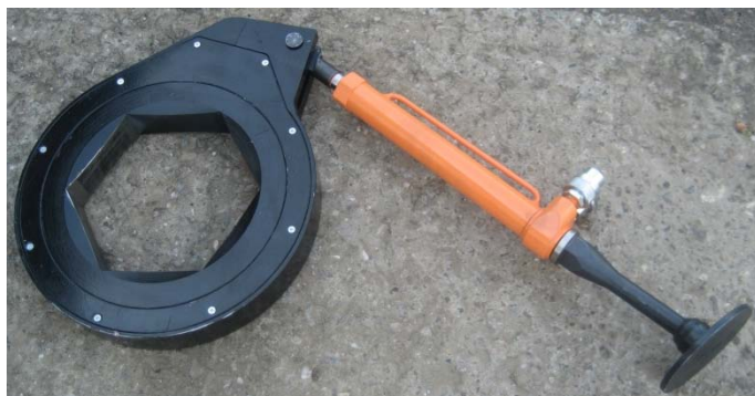
CH.S180 echipata standard permite strangerea/ desfacerea piulitelor/ suruburilor M120x4
